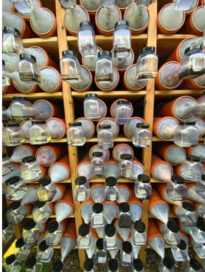
Abb.1: Zuchtanlage für Dungdipteren mit Eklektoren auf Grundlage von KG-Rohren. Die Erfassung der sich kontinuierlich im Dung entwickelnden Fliegen und Mücken bereitet nicht unerhebliche methodische Schwierigkeiten. Foto: Christian Kassebeer
